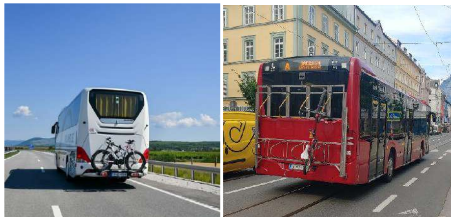
9-39. ábra: fent: kerékpár szállítása egy fővárosi autóbuszon, bal lent: hátfalra szerelhető rögzítő eszköz egy hazai távolsági autóbuszon, jobb lent: helyi autóbusz hátfalára szerelt rögzítő eszköz Innsbruckban
